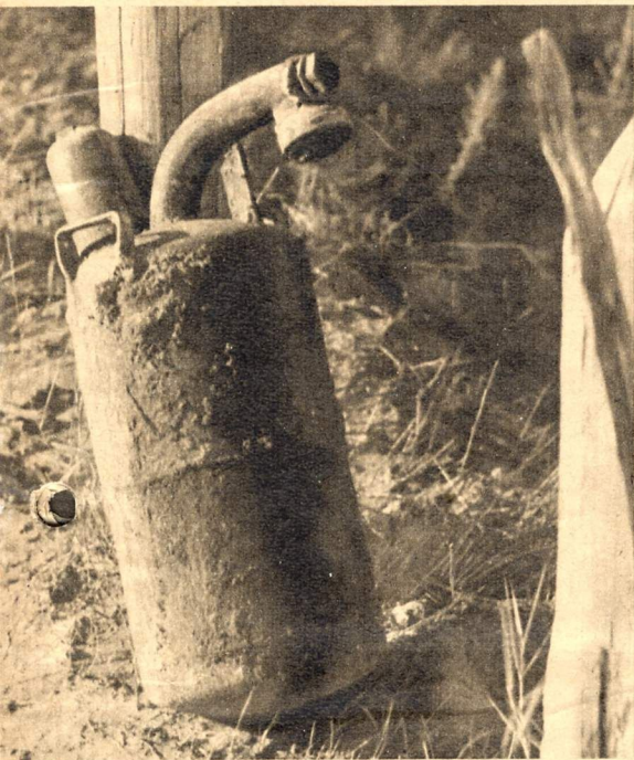
E iner der an der Rollbahn ausgegrabenen Flammenwerfer, die von den Sowjets so eingerichtet waren, daß sie wie eine Mine automatisch zur Auslösung kamen
